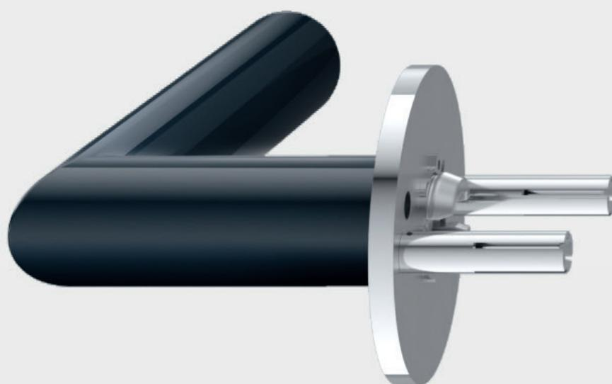
Die innovative Montagetechnik von bicolor ermöglicht eine extrem schnelle und dauerhafte Befestigung ohne Schrauben. Zur Befestigung werden Rasthülsen und Gewindebolzen ineinander gesteckt, sodass sie zugfest miteinander verrasten. Die Schnellverbindung ermöglicht eine einfache Montage und Demontage. Feuerschutzgarnituren nach DIN 18273 vervollständigen das Objektsortiment.
